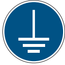
M005: Erdung erforderlich
