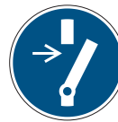
M021: Vor Arbeiten freischalten
