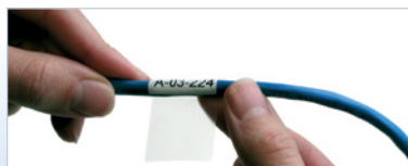
Wickeln Sie den transparenten Bereich um die Leitung, um den bedruckten Bereich abzudecken.
