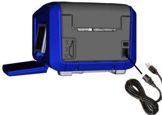
2. Das andere Ende des Netzkabels in eine Netzsteckdose einstecken.
