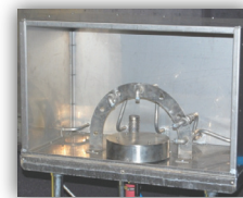
Abbildung 2 Sprühdüsenaufbau für Simulationssysteme gemäß IP69K und Darstellung eines echten Sprühsystems.
