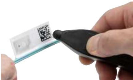
Die UHF/RFID-Etiketten werden direkt vor Ort mithilfe von speziellen, programmierbaren UHF/RFID-Druckern gedruckt und kodiert. Auf diese Weise kann das ICT-Unternehmen jedes RFID-Etikett mit einer eindeutigen Nummer versehen, sodass jeder gekennzeichnete Gegenstand automatisch und präzise nachverfolgt werden kann.
